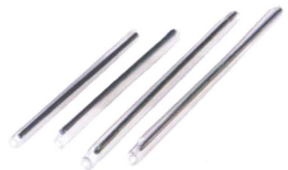
Manchons thermo-rétractable 40 mm & 60 mm avec barreau métallique pour renforcer la soudure / épissure optique
